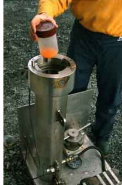
Figure 7 : Appareil utilisé pour administrer le choc de pression aux œufs nécessaire à produire des embryons triploïdes (3N)
